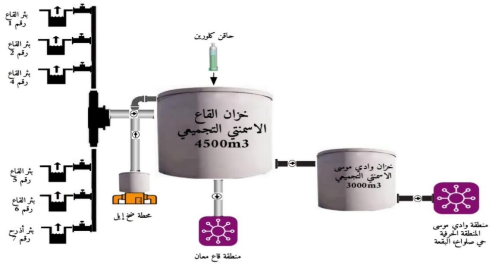
رسم توضيحي 4. الخزانات التجميعية التي تغذي إقليم البتراء بمياه الشرب
